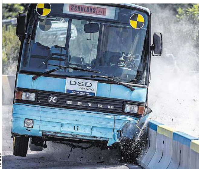
Die TU Wien zeigt in einem Versuch wie schwere Fahrzeuge zurück in die Spur geleitet und Folgeunfälle vermieden werden
