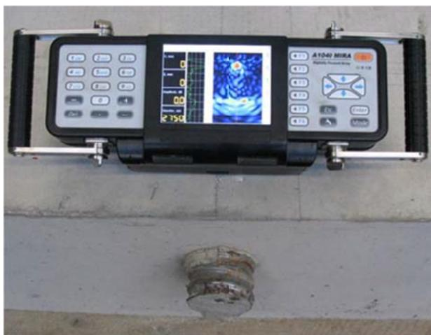
**Abbildung 2: Linear-Prüfkopfarray A1040 MIRA mit SAFT-Rekonstruktionsrechnung und Bilddarstellung. [4]**
