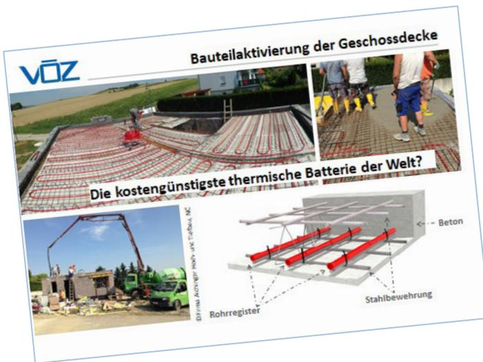
Die Wärmepumpe ist direkt an die aktivierten Betonbauteile angeschlossen. Als Wärmespeicher für die Warmwasserbereitung wird ein Pufferspeicher herangezogen. Über eine Frischwasserstation wird das benötigte Warmwasser im Durchlaufprinzip erwärmt. Das Pufferspeichervolumen beträgt 1.000 l.
