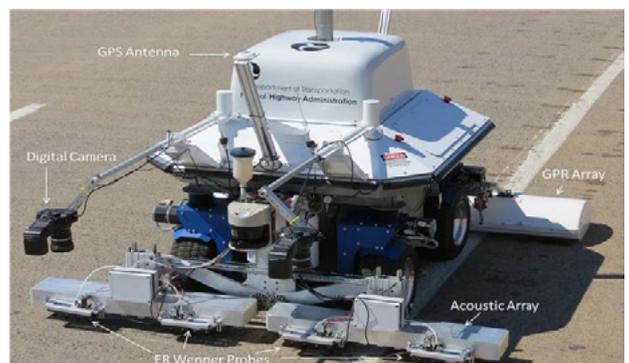
**Abbildung 4: Roboterplattform mit einer Vielzahl verschiedener ZfP-Verfahren zu simultanen orts aufgelösten Messung. [18]**
