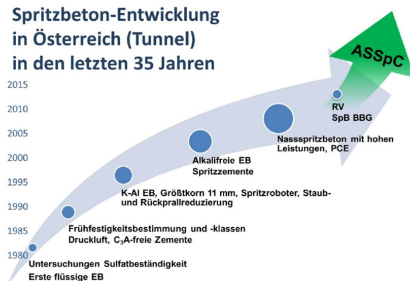
*Bild 1: Die Spritzbetonentwicklung der letzten 35 Jahre in Stichworten; EB Erstarrungsbeschleuniger; Hochleistungsverflüssiger vom Typ PCE, RV reduziertes Versinterungspotential, BBG Brandbeständigkeit im Großversuch*
