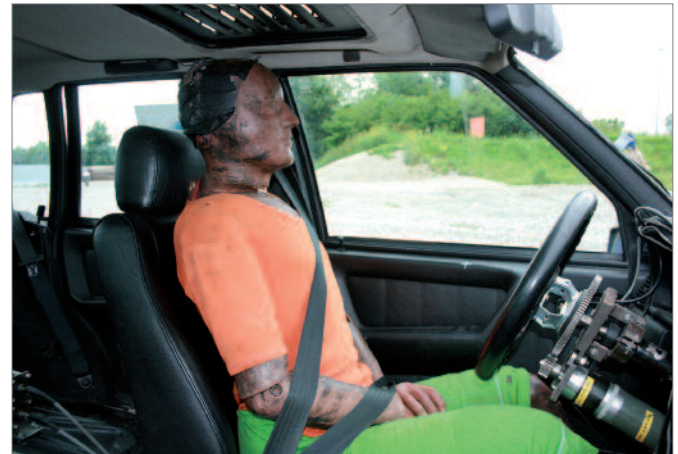
Bild 9: Dummi bei TB 11 Versuch gemäß ÖNORM EN 1317
