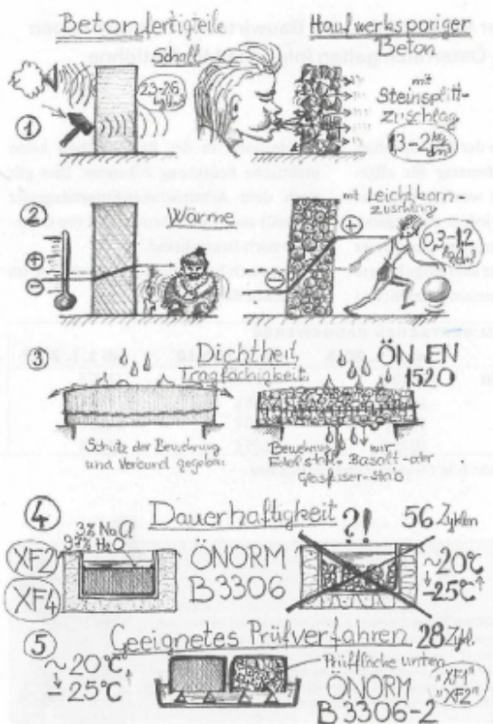
Bildhafter Vergleich von normalen Betonfertigteilen mit Bauteilen aus haufwerksporigem Beton. (XF1 = Prüfung im Wasser, ohne Salt, XF2 mit wässriger 3% Kochsalzlösung)
