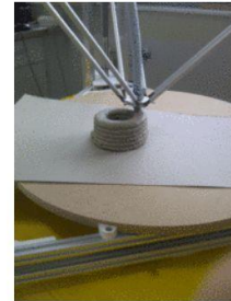
Beton wird gedruckt statt geschalt
