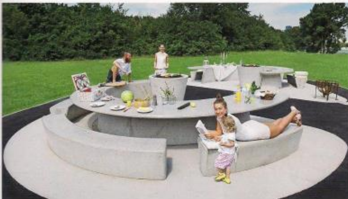
Diese Barbecue-Stationen auf der Donauinsel geben einen neuen Standard für Freizeitmöbel des öffentlichen Raums vor. Um die weichen Formen des Entwurfs zu realisieren, wurde mit einer speziellen 3D Software eine Stahlschalung hergestellt.
