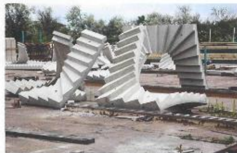
Lagerung der Fertigteil-Treppen bei Oberndorfer © VOEB
