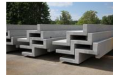
Lagerung der Tribülenelemente
