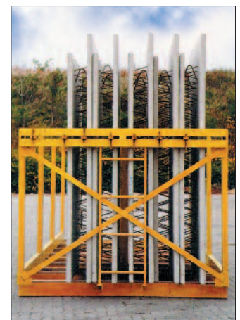
Bild 7: Transportbox für Doppelwände
