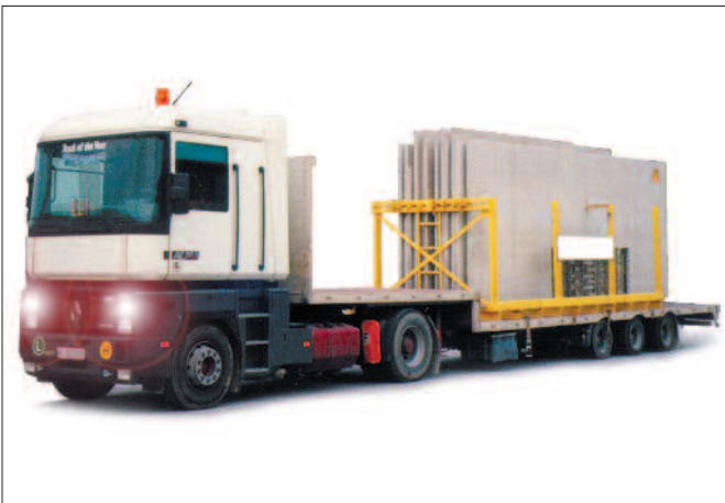
Bild 18: Tiefbettsattel mit beladener Transportbox
