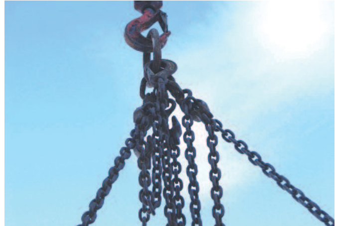
Bild 7: Ketten bzw. Seilgehänge immer auf Zug führen
