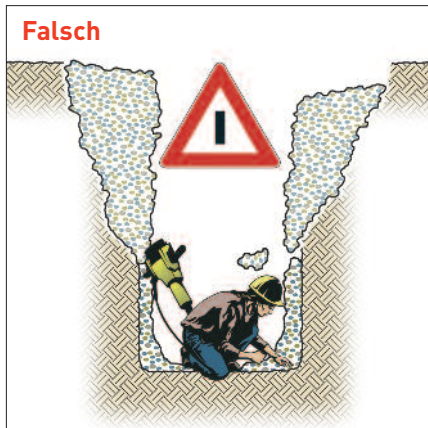
Gefahr: Künette nicht abgesichert
