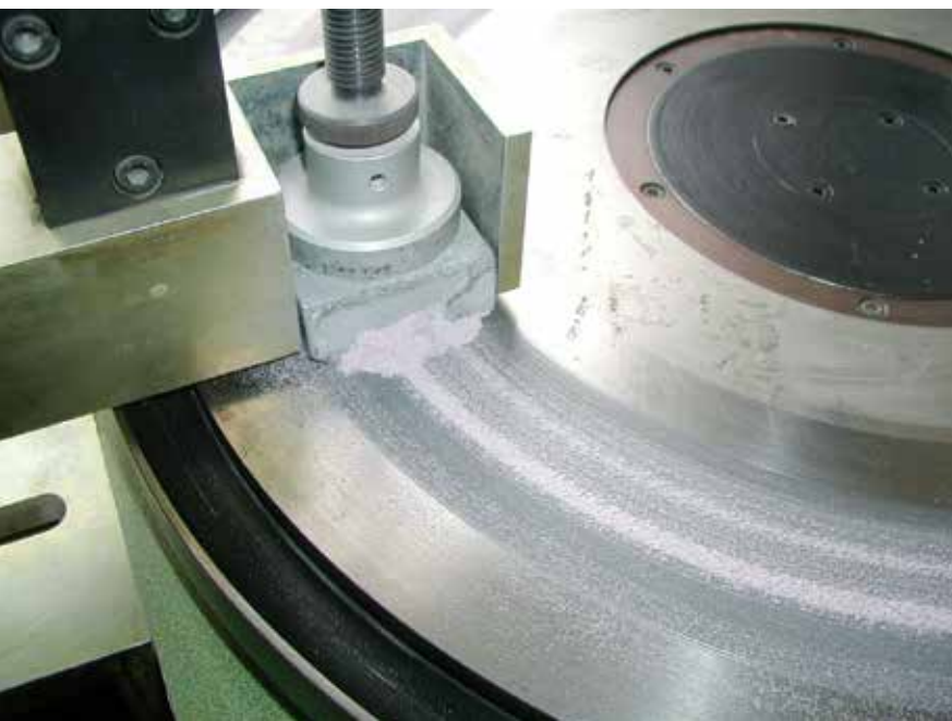
Bild 4: XM1 Prüfung mechanischer Abrieb nach Böhme
