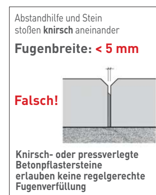
Abb. 1b: Fugenbreite = Vorsprungsmaß der Abstandhilfe (Abstandsnoppe)
