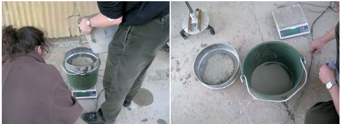
Abb. 8.4: Siebtest zur Prüfung der Sicherheit gegen Entmischung
