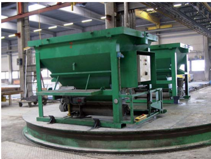
Abb. 12.1: Verwendung eines Behälters mit Rührwerk, um den SCC genau vor dem Einbau zu aktivieren
