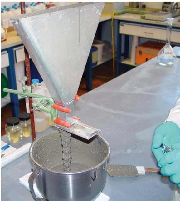
*Bild 4.2: Laborversuchsanordnung für Feinbetonversuch – Fließzeit*
