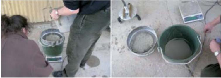
Siebttest zur Prüfung der Sicherheit gegen Entmischung
