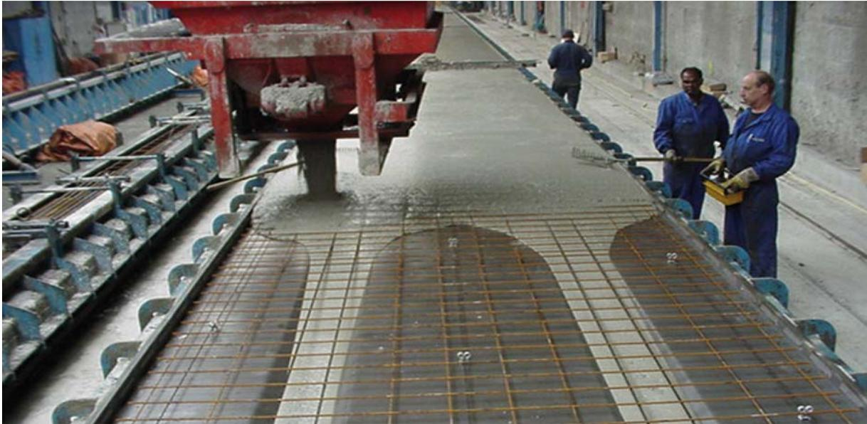
*Verwendung von SCC im Betonfertigteilwerk*
