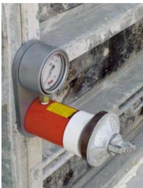
Abb. 8: Druckmessdose
