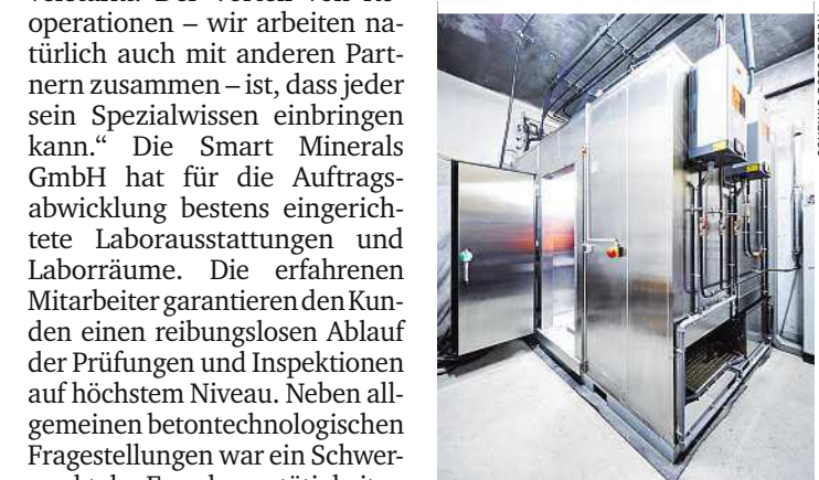
Die Klimakammer dient zur Simulation von Umwelteinwirkungen
