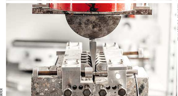
Mit der Keilspaltprüfung werden Verbundeigenschaften getestet
