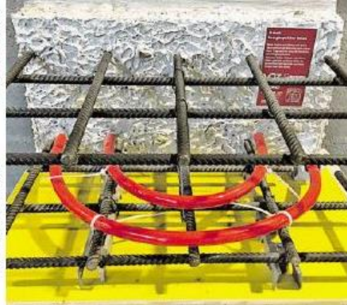
Durch Rohrsysteme wird warmes oder kaltes Wasser in den Beton geleitet.
