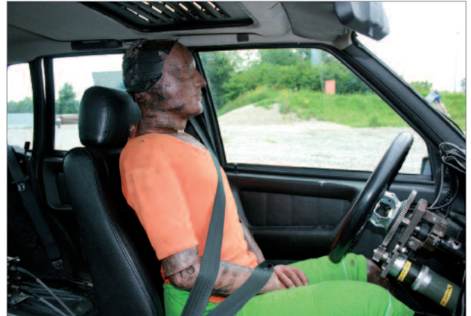
Bild 9: Dummi bei TB 11 Versuch gemäß ÖNORM EN 1317
