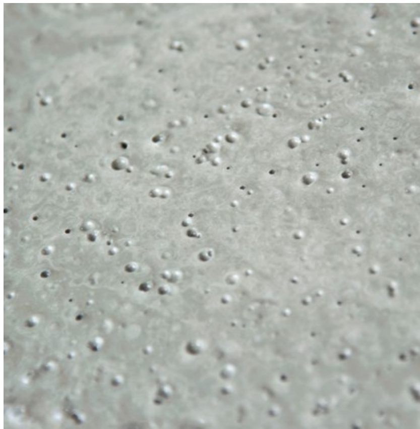
Bild 4.4: Der in die Schalung eingebrachte Beton muss unbedingt sorgfältig verdichtet werden.
