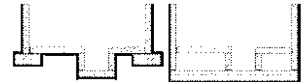
Grafik 8.8: Braune Wanne – Fundamentunterkanten sind möglichst eben auszuführen (Quelle: www.dichte-bauwerke.de)
