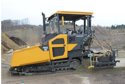
Der Kettenfertiger Volvo P8820C ABG schafft eine Einbauleistung bis zu 1.100 Tonnen pro Stunde
