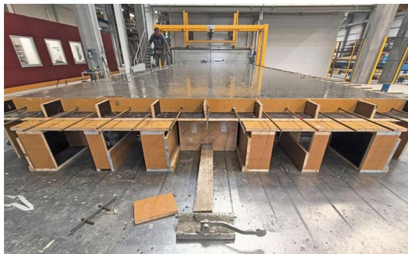
Betonierstation im Fertigungswerk.
