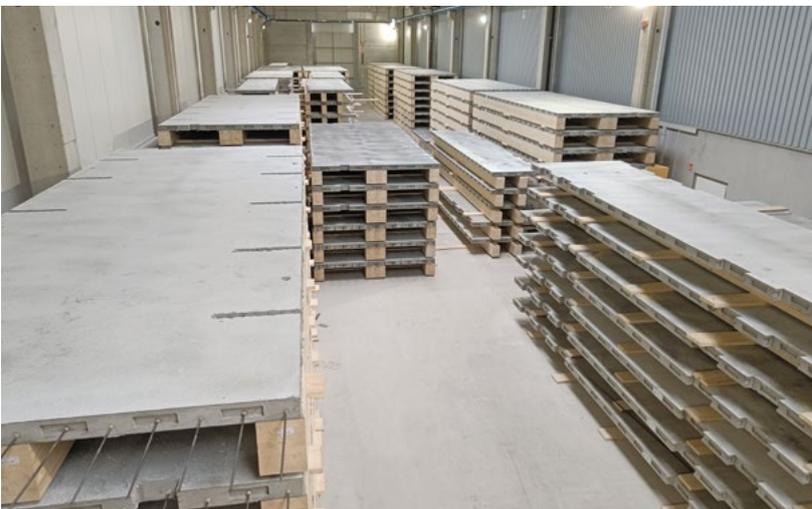
Lagerung der fertigen HB-Verbunddecken.
