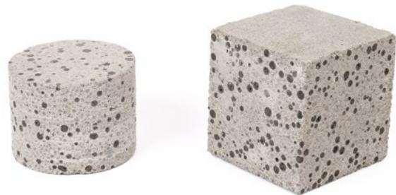
Infraleichtbeton-Proben – Rezeptur mit Blähton und Blähglas.
