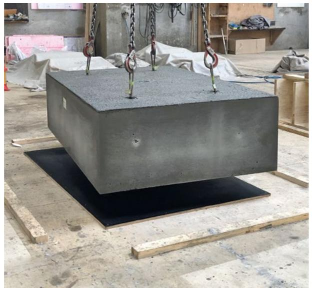
Prüfplatte zur Untersuchung der Frühfestigkeit von Infralichtbeton.
