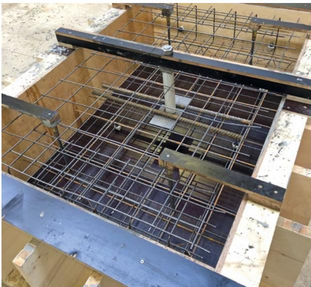
Flachstahllanker in der Schalung der Prüfplatte.
